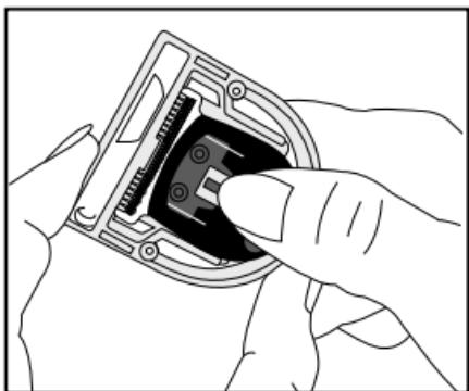
Nástroj automaticky zatlačí pohyblivé čepele dolů do standardní polohy.
