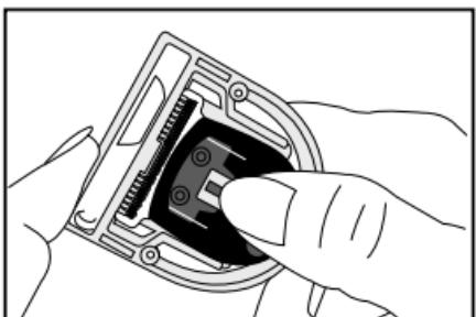
Alat će pomicnu oštricu automatski spustiti s njenog početnog položaja.
