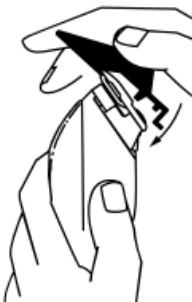
Eemaldamiseks lükake tagaosa üles ja eemaldage tera.
