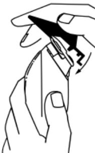
Eemaldamiseks lükake tagaosa üles ja eemaldage tera.
