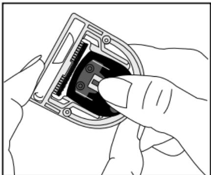
Dispozitivul va împinge automat lama mobilă în jos, către poziția inițială.
